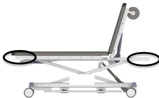
Schéma 1.1 Points de levage
