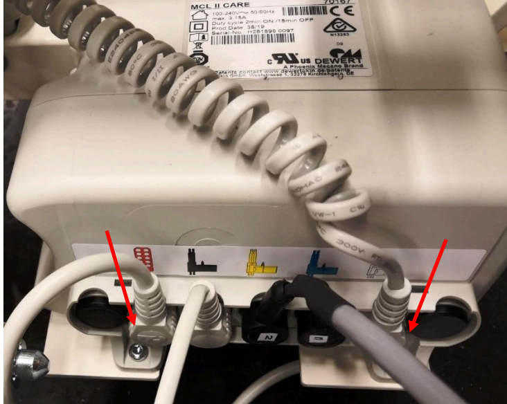
Abbildung 47. Abnehmen des Steuergerätes
