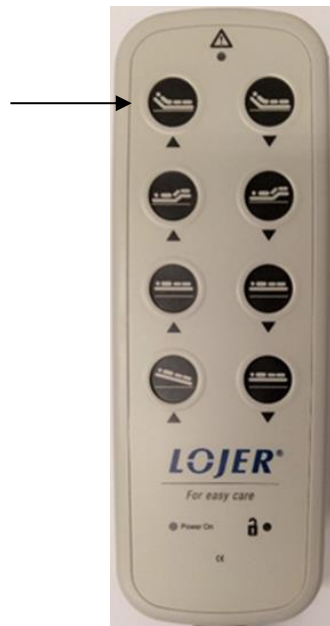
Abbildung 31. Zusammenklappen des Bettes in die Transportposition
