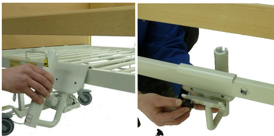
Abbildung 33. Montage des Rahmens und der Montageplatte und Befestigung der Rändelschrauben
