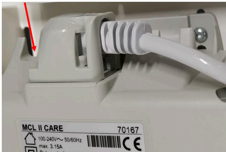
Abbildung 48. Entfernen des Verriegelungsteils der Netzkabel
