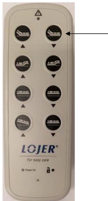
Abbildung 15. Einstellen der Schlaffläche in die Betriebsposition
