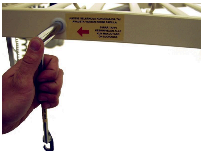
Abbildung 30. Verriegelungshakenstift in dem Verriegelungsloch der Rückenpartie
