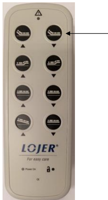
Abbildung 15. Einstellen der Schlaffläche in die Betriebsposition
