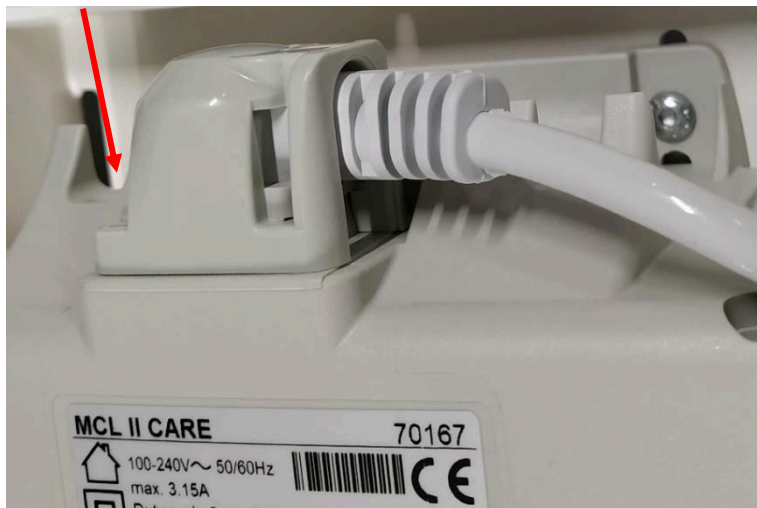
Abbildung 48. Entfernen des Verriegelungsteils der Netzkabel
