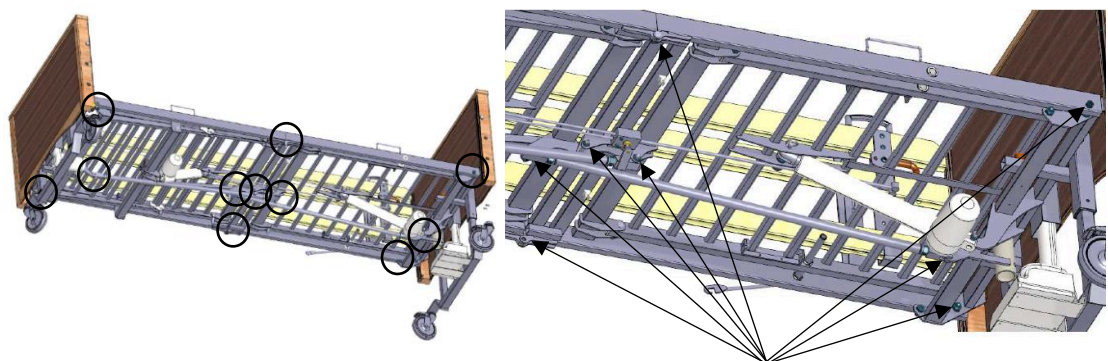
Abbildung 43. Schmieren der Punkte des Klappmechanismus
