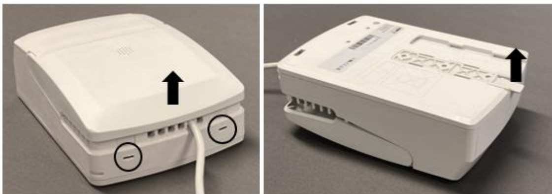
Abbildung 34. Auswechseln des Akkus
