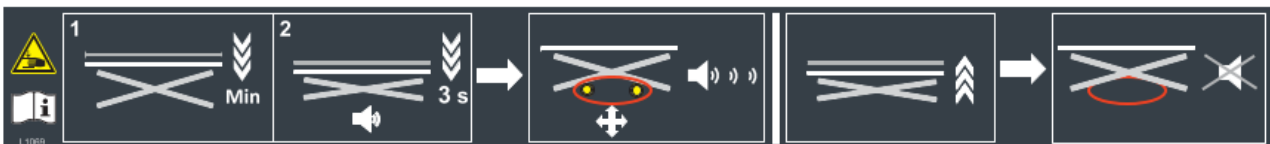
Abbildung 1. Aufstellen des Tisches auf den Lenkrollen und Herunternehmen von den Rollen
