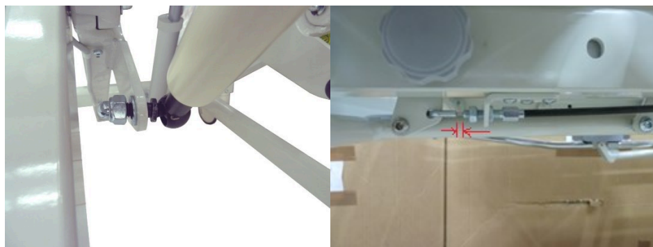
Figure 79. Gasdruckfeder am unteren Ende und freies Spiel des Drahtes im Griff
