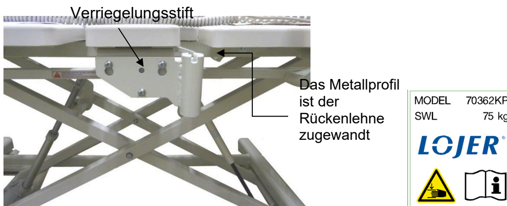
Figure 47. Eine installierte Schnellmontageplatte und Aufkleber der Hubstütze
