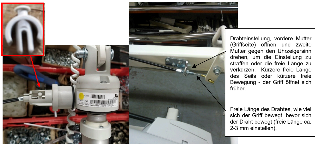
Figure 70. Rückenlehnenaktuator CPR-Kabel entfernen und einstellen
