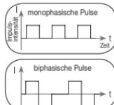
Im Digital EMS/TENS finden sich ausschließlich biphasische Pulsströme, da sie den Muskel entlasten, zu einer geringeren Muskelermüdung sowie zu einer sichereren Anwendung führen.
