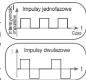
Rozróżnia się jednofazowe i dwufazowe prądy impulsowe. W przypadku jednofazowych prądów impulsowych prąd płynie w jednym kierunku, w przypadku prądów dwufazowych prąd wzbudzenia zmienia swój kierunek. W cyfrowym urządzeniu do elektrycznej stymulacji mięśni i nerwów EMS/TENS działają tylko dwufazowe prądy impulsowe, ponieważ odciążają one mięśnie, powodując mniejsze zmęczenie mięśni oraz zapewniają bezpieczniejsze zastosowanie.
