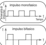
Si distinguono correnti ad impulso di tipo monofasico e bifasico. Nelle correnti ad impulso monofasico la corrente scorre in una direzione, in quelle ad impulsi bifasici invece la corrente di eccitazione alterna la sua direzione.
