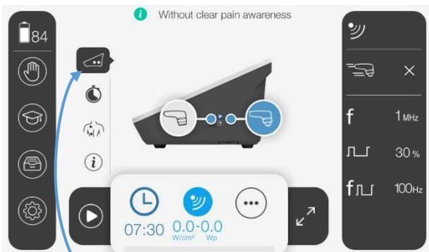
**Drücken, um zwischen den angeschlossenen Ultraschallköpfen zu wechseln**
