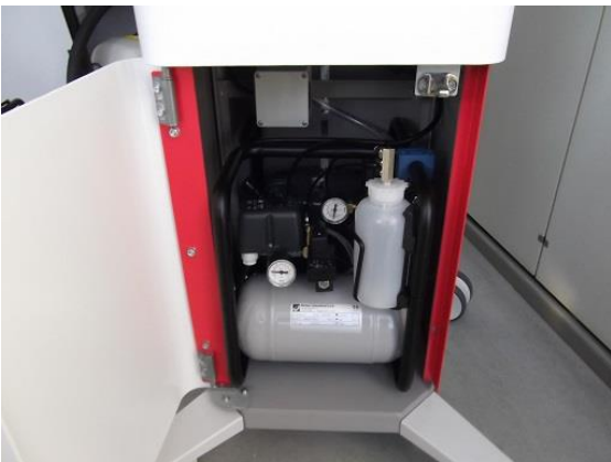
Abb. 7 Kompressor in den Trolley stellen (wie auf Abbildung)
