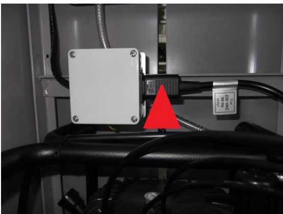
Abb. 8 Hauptstecker des Kompressors in die Steckdose am Trolley stecken
