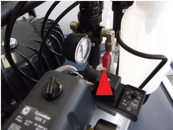
Abb. 4 Hahn aufdrehen (abgestimmt auf den Luftstrom)
