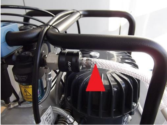
Abb. 3 Luftschlauch - wenn separat geliefert - anschließen
