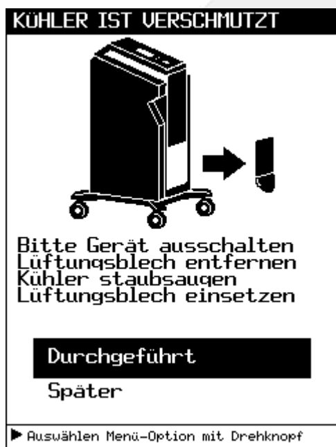
Bild 10: „Reinigung des Kühlers“
