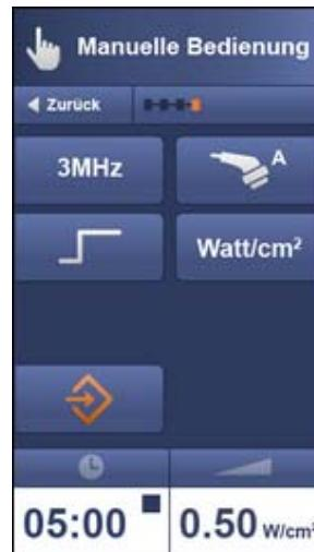
Falls der kontinuierliche Impulsmodus ausgewählt ist, sind keine weiteren Parameter (Frequenz oder Duty Cycle) verfügbar.
