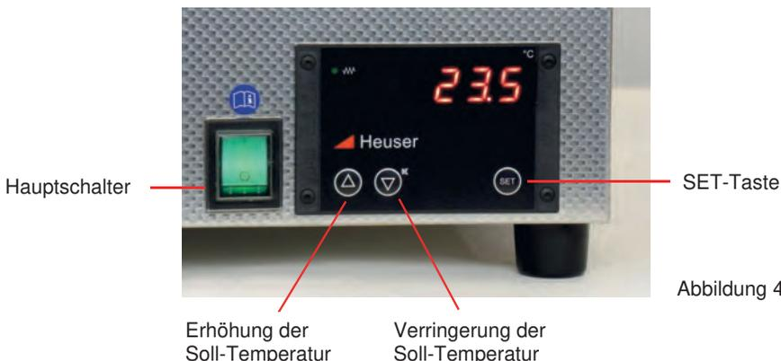
Die Wasserbäder WB werden am grünen Hauptschalter auf der Gerätevorderseite (Abbildung 4) eingeschaltet. Die Einstellung der Solltemperatur erfolgt durch gleichzeitiges Drücken der Taste SET und der Taste ▲ oder ▼. Die gewählte Temperatur bleibt auch nach dem Ausschalten des Wasserbades WB erhalten. Beim Wiedereinschalten beginnt sofort, auch bei entleertem Wasserbad, der Heizvorgang.
