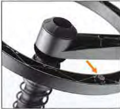
Zum Wechseln der Gleitfüße stellen Sie den „swopper“ vorsichtig auf den Kopf und ziehen Sie die Metallgleiter mit einer Zange heraus. Setzen Sie die Filzgleiter an deren Stelle und drücken oder klopfen Sie diese fest. Fertig!
