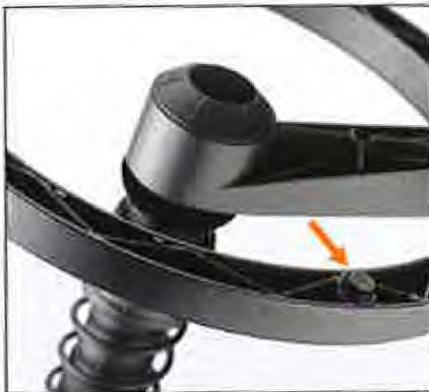
Om de glijvoeten te vervangen zet u de „swopper“ voorzichtig omgekeerd neer waarna u de metalen vloerglijders met een tang eruit trekt. Breng aansluitend de vilten vloerglijders aan en druk of klop deze vast. Klaar!
