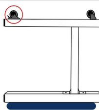
Setzen Sie das erste Seitenteil **2** auf den Rahmen, so dass die Bohrlöcher übereinanderliegen. Die Rolle mit Bremse zeigt zu Ihnen.
