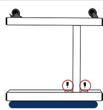
Setzen Sie die beiden Schrauben **3** ein und ziehen Sie diese mit dem Innensechskantschlüssel **4** fest.
