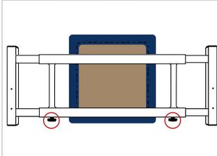
Legen Sie den Rahmen mit Kissen **1** auf den Boden, so dass die Holzplatte nach oben zeigt. Die Stellschrauben zeigen zu Ihnen.
