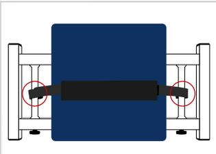
Befestigen Sie den Gurt **5** an den beiden Mittelstreben des Rahmens **1**.
