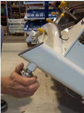
Bild 5: Anschrauben der Einstellungsunterlagen
