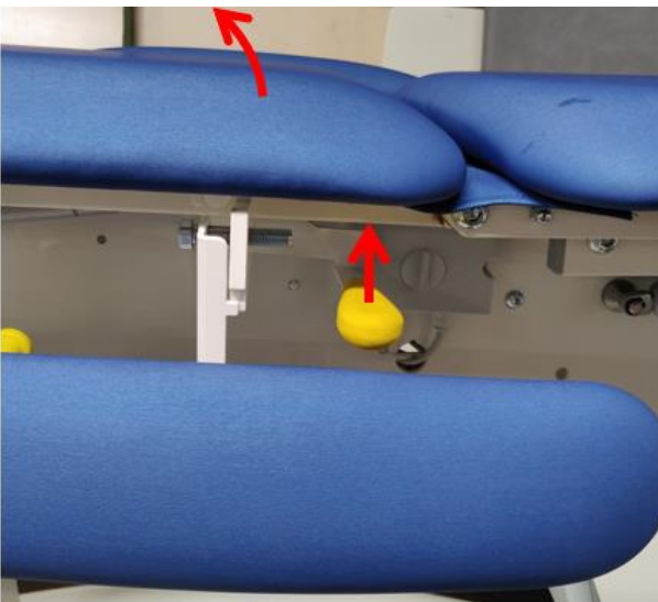
Abbildung 17: Einstellhebel des Mittelteils
