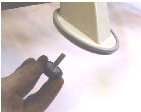
BILD 5 Einbau der Verstellschrauben
