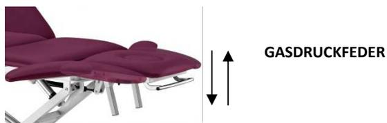
Um das Aus- und Einfahren der Gasdruckfeder zu steuern, ziehen Sie den unter dem jeweiligen Liegenteil positionierten Bedienungshebel. Heben oder senken Sie den entsprechenden Tischabschnitt, bis er die gewünschte Kippstellung erreicht hat. Lassen Sie den Hebel **langsam** los, um den Abschnitt in die gewünschte Kippstellung zu bringen. Abrupte Freigabe sperrt den Abschnitt sofort.
