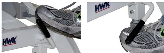
Damit die Liege nach der Ortsveränderung wieder in eine stabile Standposition gebracht werden kann, müssen die beiden Fußhebel mit dem Fußrücken angehoben werden. Die Arretierung wird dabei überwunden, die Rollen fahren nach oben ein und die Liege steht dadurch wieder auf ihren Standfüßen.
