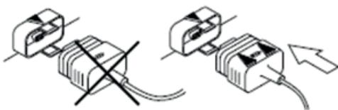
Den D-SUB-Stecker des Bedienelement-adapters in die vorgesehene Buchse (1) der Steuereinheit (Bild 1) einstecken.
