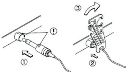
Einstecken des Antriebs in die vorgesehene Buchse (2) der Steuereinheit (Bild 1)
