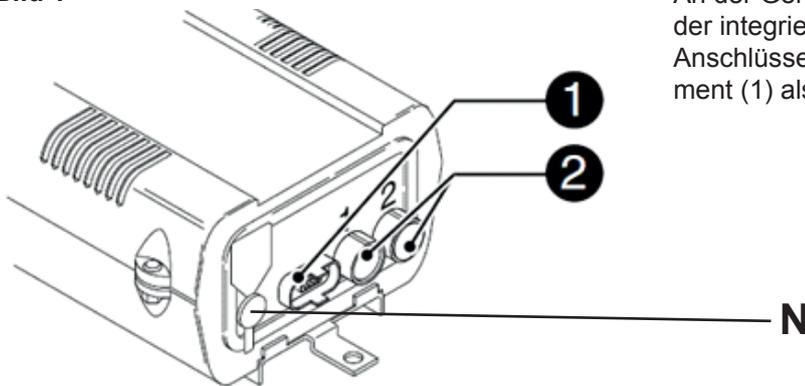
An der Gehäusestirnseite (Bild1) der Steuereinheit mit der integrierten Akkuladeeinrichtung befinden sich die Anschlüsse sowohl für den Antrieb (2), das Bedienelement (1) als auch für das externe Steckernetzteil (N).
