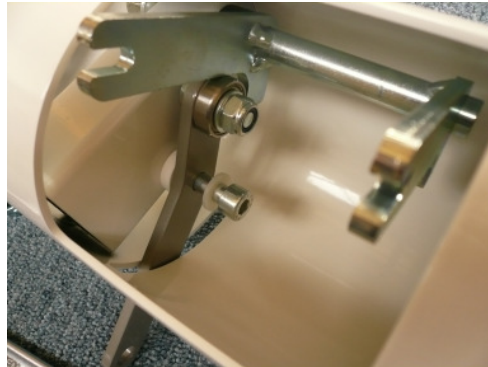
Abb. Rollengabel mit Hebel auf der rechten Seite
