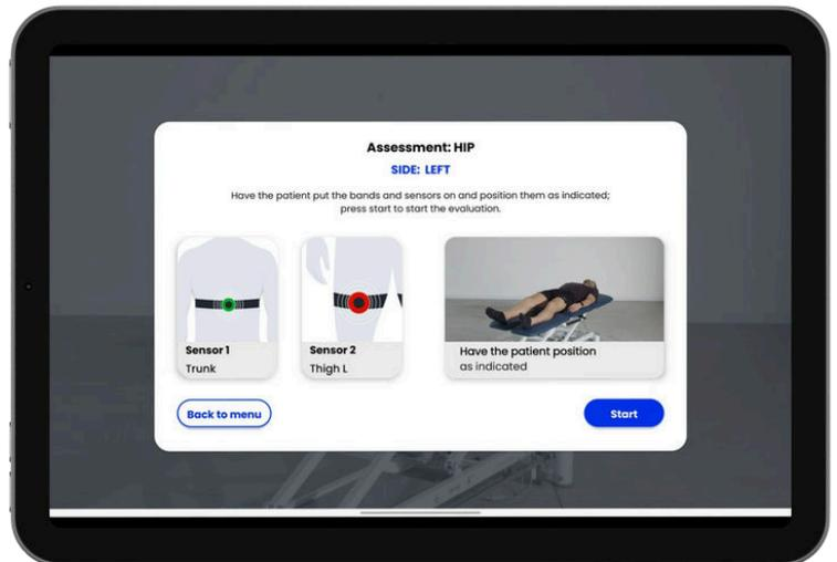
Bei der Bewertung eines **ROM** wird dem **Fachmann** angegeben, welche **Sensoren** zu verwenden sind und welche Position für den **Benutzer/Patienten** empfohlen wird. Nach einer Kalibrierungsphase beginnt die **Auswertung** automatisch mit der Aufzeichnung der ausgewählten **Bewegungen** in der vom Fachmann festgelegten Reihenfolge und Häufigkeit.
