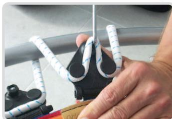
En changeant la position du câble de position **3** à position **4**, vous obtiendrez une tension plus grande.
