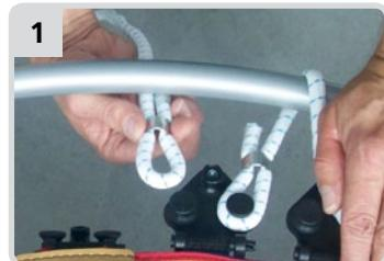
Das Ende des einzusetzenden Kabels am freien Spannelement einhängen.
