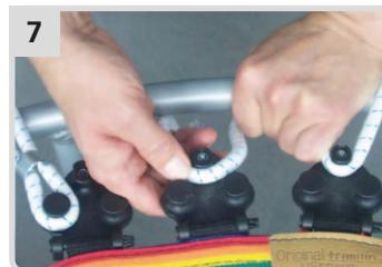
Faites passer le câble autour du cône souhaité de l'élément de serrage suivant.
