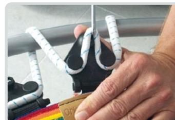
Zur Erhöhung der Spannung am variablen Spannelement z.B. von Position 1 auf Position 3 oder 4, müssen Sie das Kabel zuerst über die Zwischenposition 2 führen.
