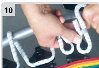
Das Ende des Kabels am letzten Spannlement einhängen.
