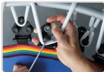
Pour augmenter la tension de la position **1** à la position **3**, passez par la position **2**.
