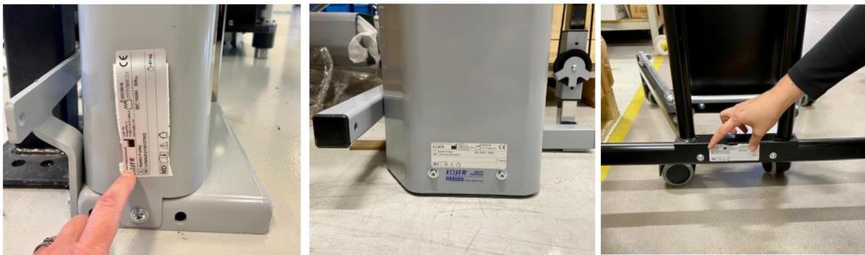
Abbildung 25. Position des Typenschildes (von links: Pulley 14 & 20 und Speed Pulley 50; Speed Pulley 80 & 100 und Vertical Pull; Mobile Speed Pulley)
