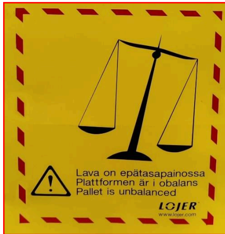
Immagine 9. Verpackungsetikett: Palette ist nicht ausbalanciert (ein Aufkleber ist an der schwereren Seite des Pakets angebracht, wo sich der Gewichtsstapel befindet)
