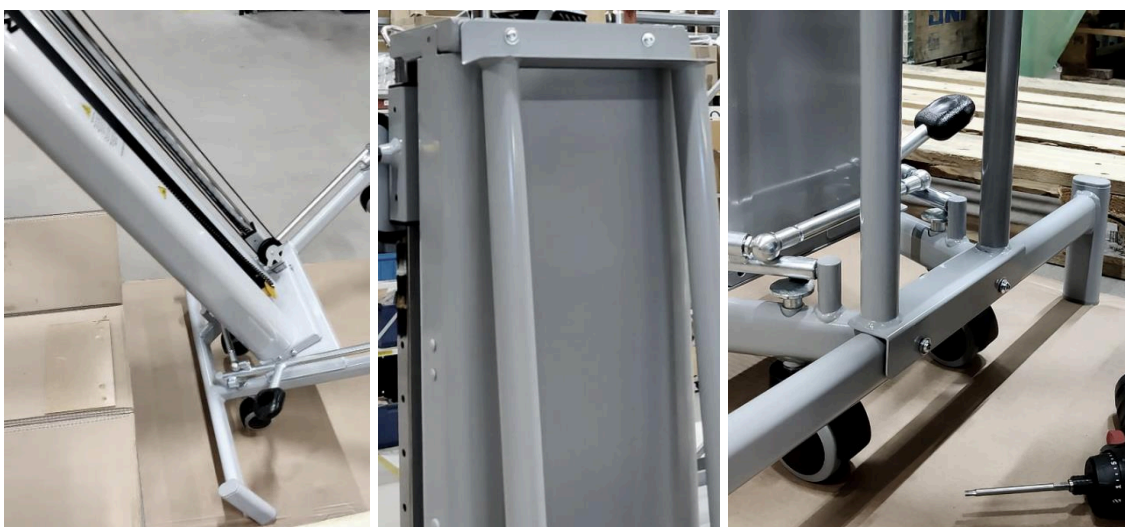
Immagine 13. Anheben des Geräts und Anbringen der hinteren Stütze
