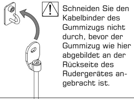
Schneiden Sie den Kabelbinder des Gummizugs nicht durch, bevor der Gummizug wie hier abgebildet an der Rückseite des Rudergerätes angebracht ist.
