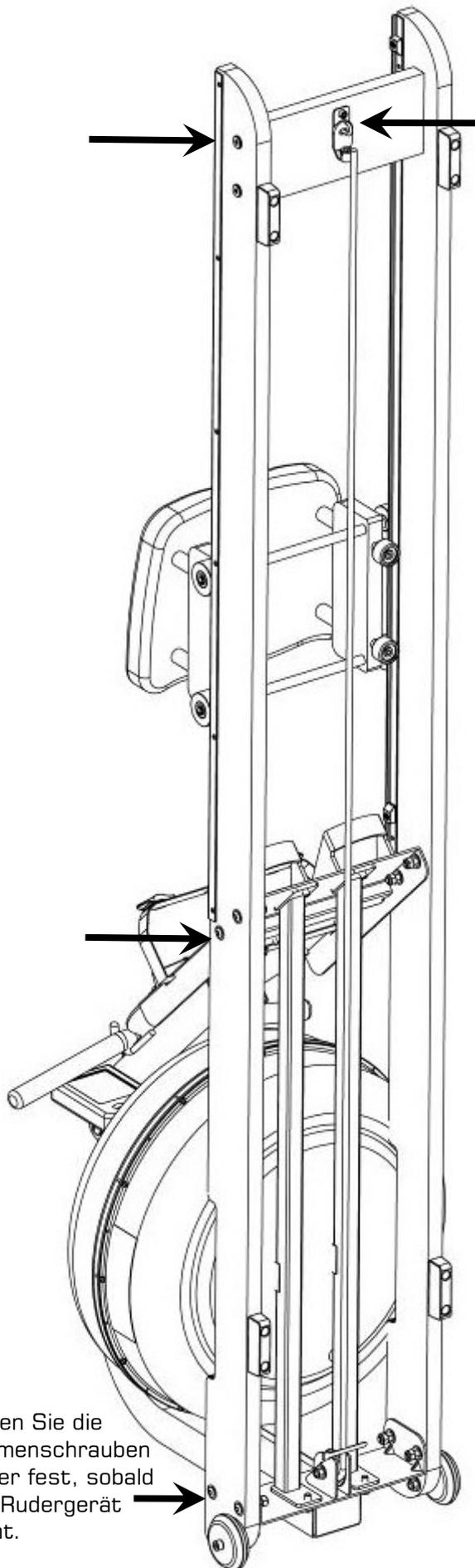
Ziehen Sie Gummizug und Hakenende wie abgebildet an die **Gummizug-Hakenbefestigung**[5].
