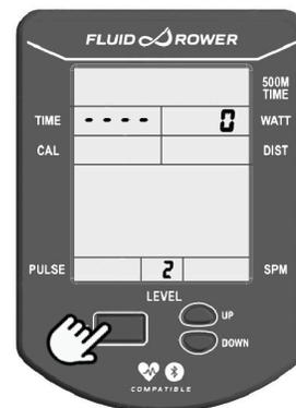
Drehen Sie den Einstellgriff auf STUFE 2. Halten Sie die Tasten 「ZURÜCKSETZEN」. Der Monitor zeigt jetzt STUFE 「3」. Dass die Kalibrierung für STUFE 2 abgeschlossen ist.
