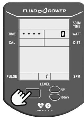
Drehen Sie den Einstellgriff auf STUFE 1. Halten Sie die Tasten 「ZURÜCKSETZEN」. Der Monitor zeigt jetzt STUFE 「2」. Dass die Kalibrierung für STUFE 1 abgeschlossen ist.
