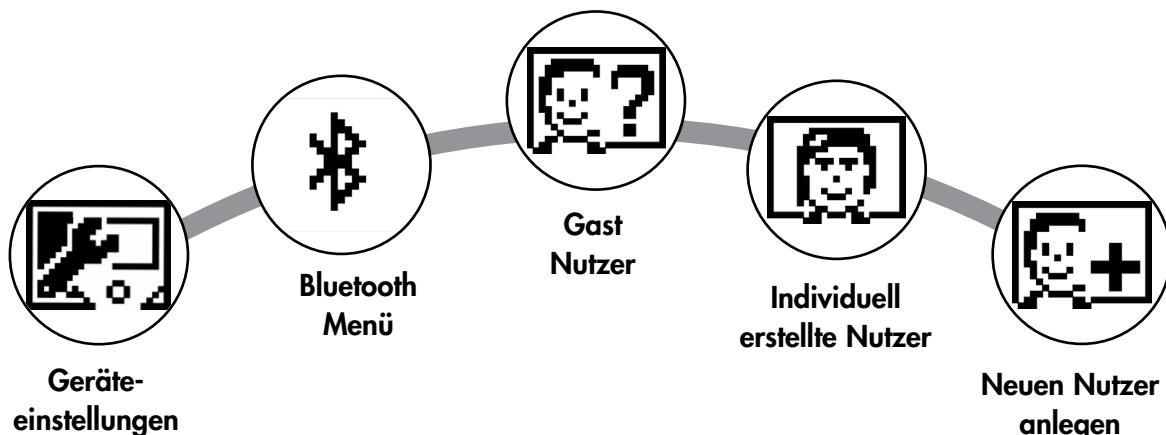
Beim Gerätetestart gelangen Sie nach einer kurzen Begrüßung in das Startmenü. In diesem Menü wird vornehmlich der Nutzer ausgewählt, auf dessen Konto trainiert werden soll. Darüber hinaus können Sie einen neuen Nutzer anlegen und unter dem Punkt "Geräteeinstellungen" nutzerübergreifende Grundeinstellungen vornehmen.
