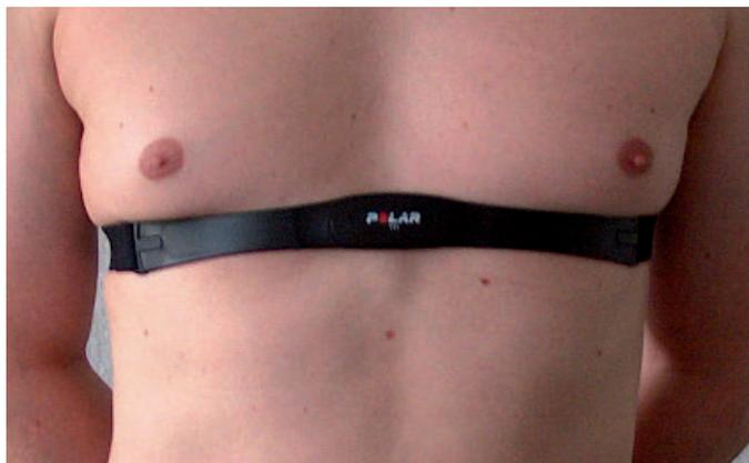
Nur wenn der Brustgurt korrekt sitzt, kann eine Pulsmessung durchgeführt werden. Ist dies nicht der Fall, erscheint auf dem Display an der Position der Pulsangabe ein „E“ (fehlerhafter oder kein Pulsempfang). Ist dies der Fall, prüfen Sie nochmals den Sitz des Brustgurtes.
