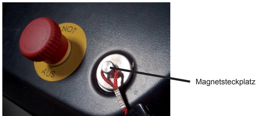
**Bitte beachten Sie:** Nur solange der Magnet auf dem Magnetsteckplatz befestigt ist, ist das Laufband funktionsfähig.
