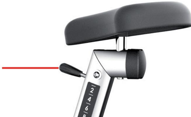
Die horizontale Sattelverstellung wird mittels Klemmhebel durchgeführt, der sich am unteren Teil der Sattelhalterung befindet. Ziehen Sie hierzu den Hebel nach oben, bis sich der Sattel verstellen lässt. Stellen Sie den Sattel in die gewünschte Position ein. Drücken Sie dann den Klemmhebel wieder in die Ausgangsposition zurück um die gewünschte Position zu fixieren.
