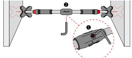
Passen Sie die Länge der Klimmzugstange an die Breite des Türrahmens an, indem Sie an der Stellschraube 1 drehen. Verwenden Sie dazu einen Innensechskantschlüssel. Die Stellschraube befindet sich an der Unterseite des Mittelteils 2. Drehen Sie so lange bis die Stange Kontakt zum Türrahmen hat.
