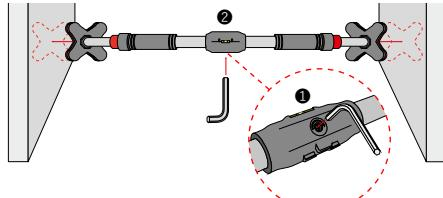
Ajustez la longueur de la barre de traction à la largeur du cadre de la porte en tournant la vis de réglage ①. Utilisez pour cela une clé Allen. La vis de réglage se trouve sous la partie centrale ②. Tournez jusqu'à ce que la tige soit en contact avec le cadre de la porte.
