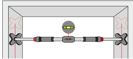
Faites maintenant glisser la barre de traction jusqu'à la position souhaitée sur le cadre de la porte. Assurez-vous que la barre est placée horizontalement dans le cadre de la porte. Le niveau à bulle intégré facilite l'alignement.
