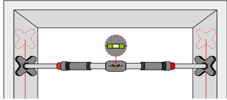
Schieben Sie die Klimmzugstange nun an die gewünschte Position des Türrahmens. Achten Sie darauf, dass die Stange waagerecht im Türrahmen platziert ist. Die eingebaute Wasserwaage erleichtert Ihnen die Ausrichtung.
