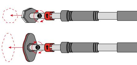
Ajustez maintenant la longueur de la barre de traction à la largeur du cadre de la porte en dévissant les deux extrémités de la barre de traction 3 jusqu'à ce que la barre soit en contact avec le cadre de la porte. Assurez-vous de dévisser uniformément les deux extrémités.
