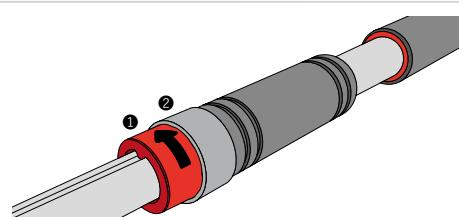
Insérez l'écrou de verrouillage rouge 1 dans l'extrémité de la poignée 2 de chaque côté pour fixer la barre de traction. Assurez-vous que les goupilles de l'écrou de verrouillage s'engagent complètement dans les logements de la poignée. Pour ce faire, il peut être nécessaire de tourner un peu plus la barre.
