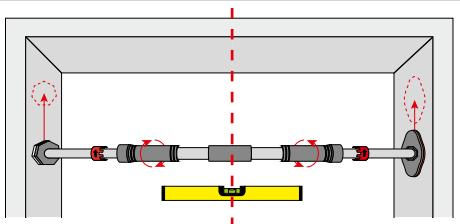
Schieben Sie die Klimmzugstange nun an die gewünschte Position des Türrahmens. Achten Sie darauf, dass die Stange waagerecht im Türrahmen platziert ist.
