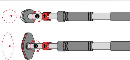
Passen Sie nun die Länge der Klimmzugstange an die Breite des Türrahmens an, indem Sie beide Enden der Klimmzugstange **3** so weit herausdrehen, bis die Stange Kontakt zum Türrahmen hat. Achten Sie darauf, beide Enden gleichmäßig herauszudrehen.
