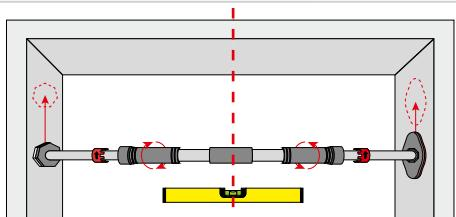
Faites maintenant glisser la barre de traction jusqu'à la position souhaitée sur le cadre de la porte. Assurez-vous que la barre est placée horizontalement dans le cadre de la porte.
