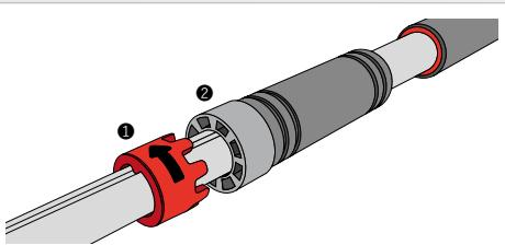
Platzieren Sie die Klimmzugstange auf dem Boden des gewünschten Türrahmens. Lösen Sie die beiden roten Verriegelungsmuttern **1** aus den Griffenden **2** indem Sie diese nach außen ziehen und so die Fixierung der Klimmzugstange lösen.
