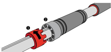
Placez la barre de traction sur le sol du cadre de porte souhaité. Desserrez les deux écrous de verrouillage rouges 1 des extrémités des poignées 2 en les tirant vers l'extérieur pour desserrer la fixation de la barre de traction.
