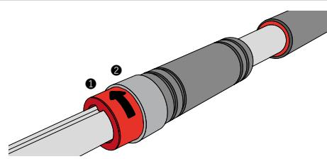
Stecken Sie auf beiden Seiten die rote Verriegelungsmutter **1** in das Griffende **2** um die Klimmzugstange zu fixieren. Achten Sie darauf, dass die Stifte der Verriegelungsmutter vollständig in die Aufnahmen des Griffs einrasten. Dazu kann es ggf. notwendig sein, die Stange noch einmal etwas zu drehen.
