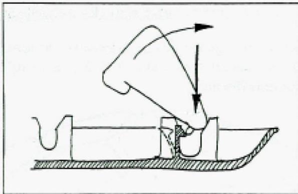
Nach der Montage der Füße müssen diese in Laufrichtung (zum Kopf hin) eingerastet und leicht zu bewegen sein.
